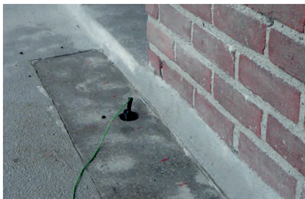
Figuur 3-6 Potentiaalmeting om corrosieplaats te detecteren.
